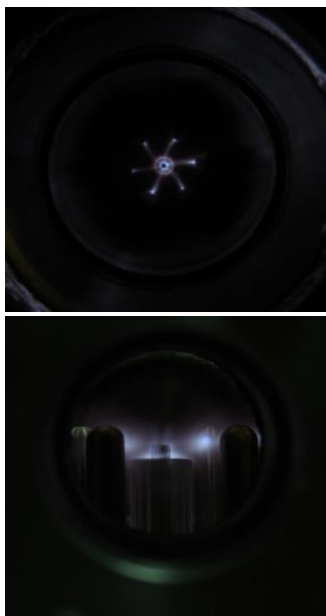
شکل ۵. تصویر نمونه‌ای از پوسته‌ی پلازما در ولتاژ شارژ بیش از ۸٫۷ kV.
