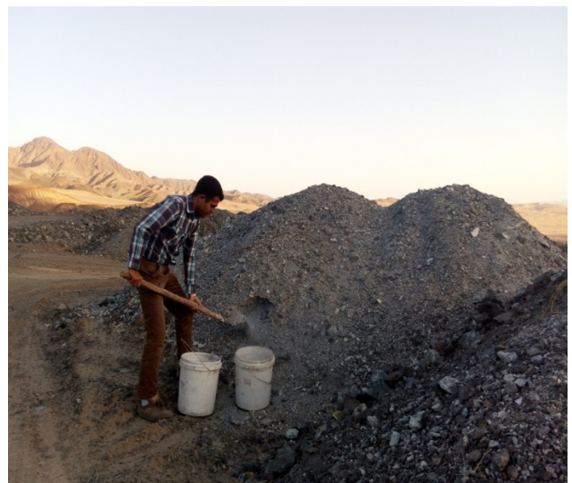
شکل ۵. تصویری از دپوی باطله معدن زیرزمینی ساغند و نمونه‌گیری مصالح سنگی برای ساخت پرکننده بتنی [۱].
