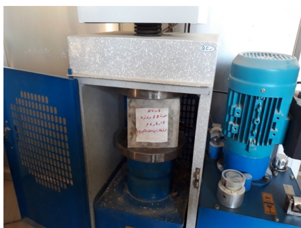
شکل ۱۱. تصویری از نحوه اندازه‌گیری مقاومت فشاری ۲۸ روزه یکی از نمونه‌های پرکننده بتنی هیدرولیکی [۱].
