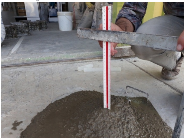
شکل ۱۰. تعیین میزان اسلامپ پرکننده بتنی هیدرولیکی.
