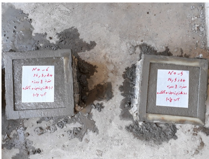
شکل ۶. نمونه‌های گرفته شده از یک طرح اختلاط پرکننده ساخته شده با باطله معدن زیرزمینی ساغد [۱].
