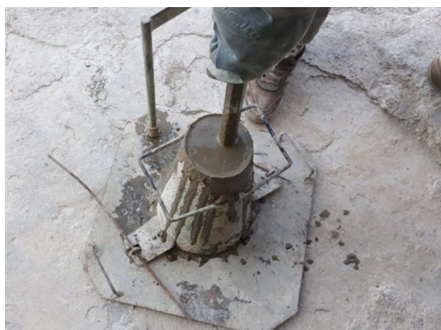
شکل ۹. نمونه آزمایش اسلامپ انجام شده برای تعیین روانی پرکننده بتنی.
