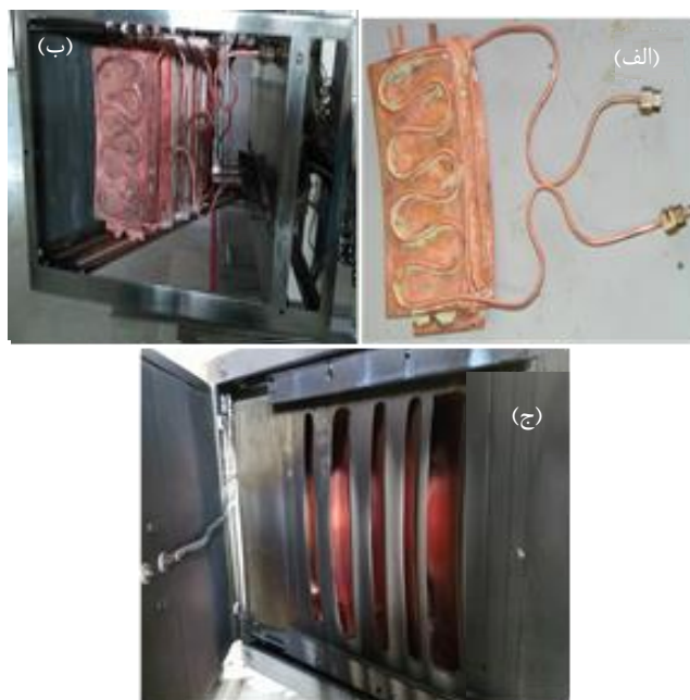
شکل ۳. الف) نمونه پاکت های مسی ساخته شده، ب و ج) نحوه قرارگیری در پشت شکاف های صفحه گرافیتی جلویی در چارچوب کلکتور.
