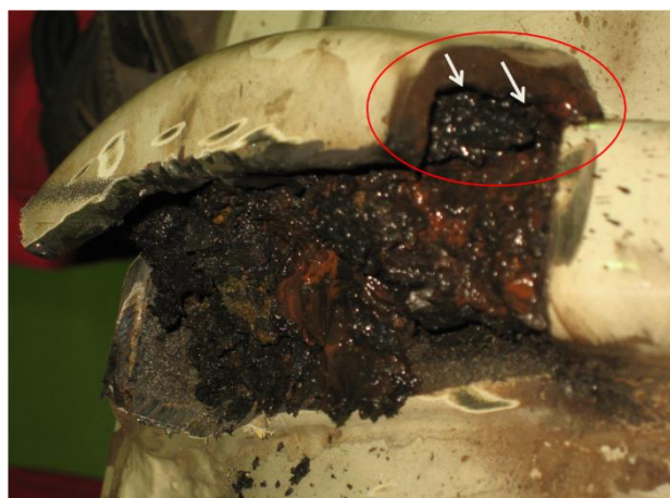
شکل ۵. سطح مقطع برش داده شده در زانویی شتاب‌دهنده به همراه محصولات خوردگی موجود.
