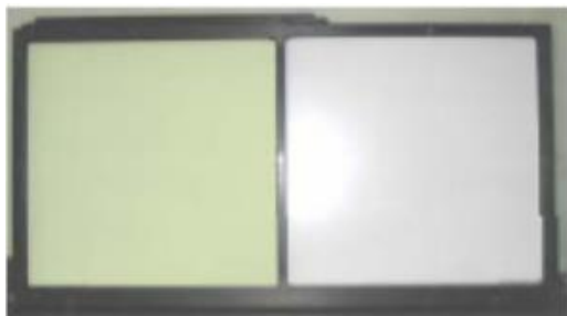
شکل ۳. صفحات سوسوزنی مورد استفاده در سیستم آشکارسازی سامانه رادیوگرافی INUS (الف) صفحه Gd_2O_3S:Tb (ب) صفحه LiF-ZnS:Cu .
