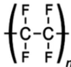
شکل ۱. ساختار تکرار شونده پلی‌تترافلورو اتیلن (تفلون).
