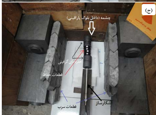
شکل ۲. طرح شماتیک و نمایی از چیدمان مورد استفاده برای اندازه‌گیری میزان عبور نوترون.
