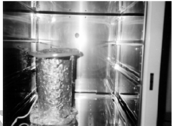
تصویر ۱- سیم پیچ سولنوئید مورد استفاده جهت تولید میدان الکترومغناطیسی
