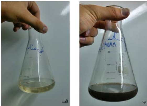
شکل ۱. تغییر رنگ محلول‌های واکنش قبل از تولید شدن نانوذرات نقره (الف) و پس از تولید شدن نانوذرات (ب)
