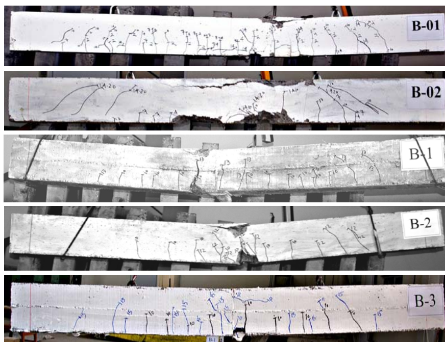
شکل ۷ نمایش رشد ترک‌ها و چگونگی شکست تیرهای آزمایشگاهی
