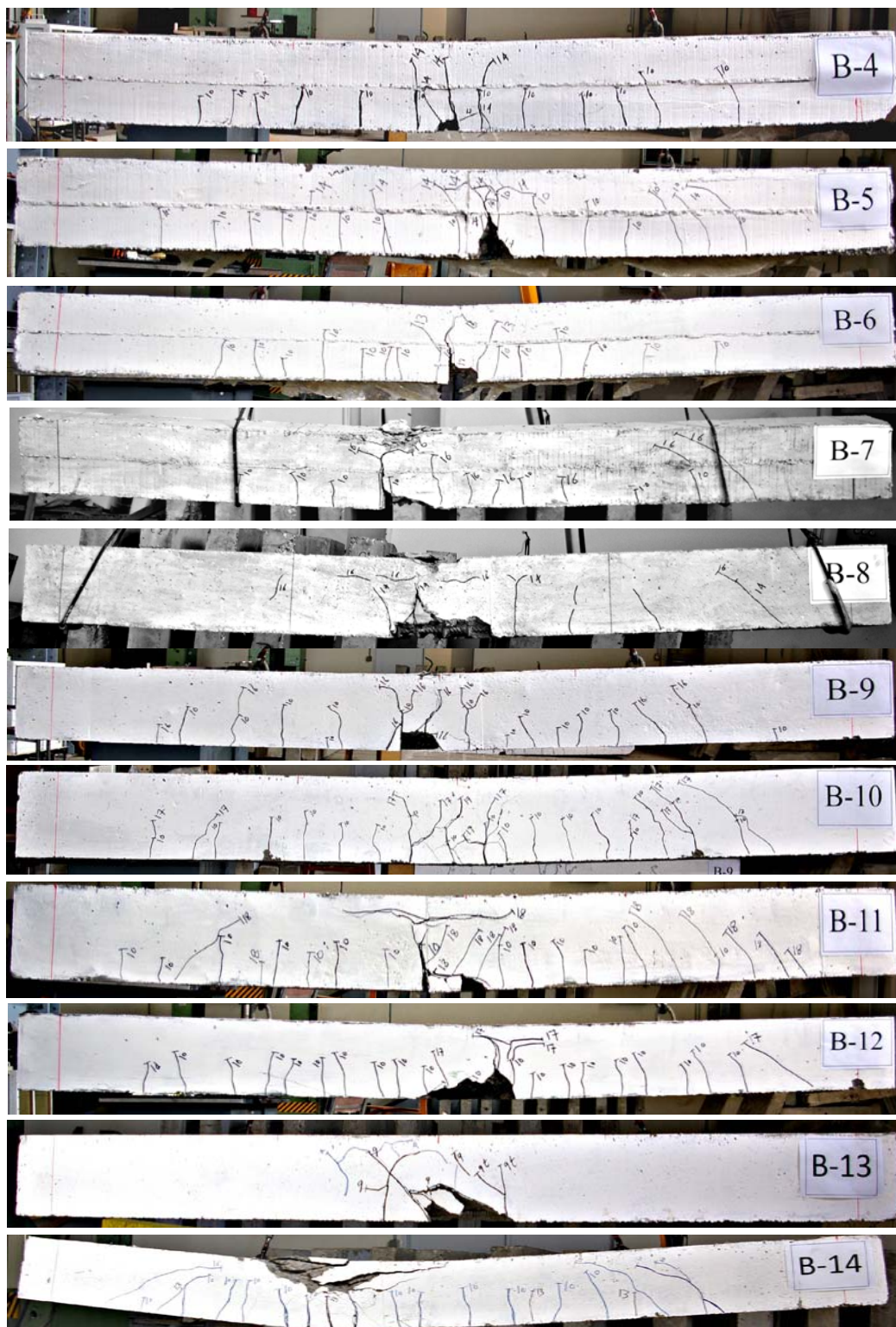
ادامه‌ی شکل ۷ نمایش رشد ترک‌ها و چگونگی شکست تیرهای آزمایشگاهی
