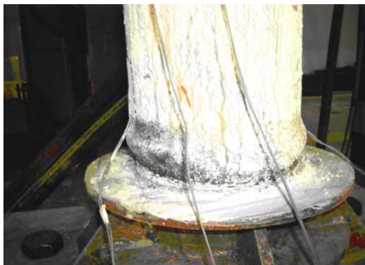
شکل ۲۵ شکست نمونه‌ی C3 در اثر کمناش موضعی حلقوی در پایین ستون
