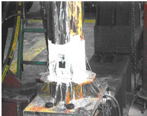
شکل ۲۴ شکست نمونه‌ی O2 در اثر کمناش موضعی جداره‌ی فولادی
