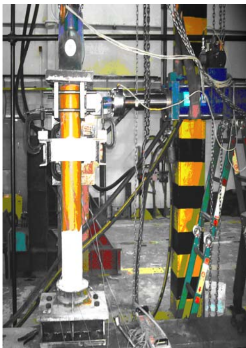
شکل ۱۰ دستگاه آزمایش برای آزمایشات نمونه‌های CFST
