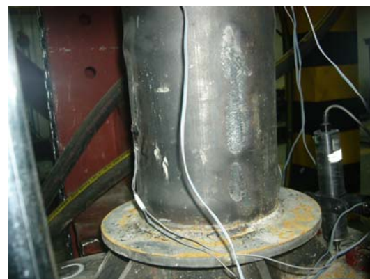
شکل ۳۳ شکست نمونه‌ی C3SN
