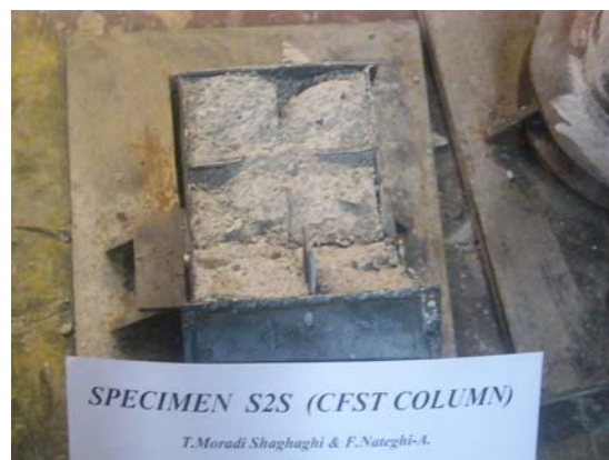
شکل ۲۹ شکست ورق‌های سخت کننده‌ی داخل نمونه‌ی S2S
