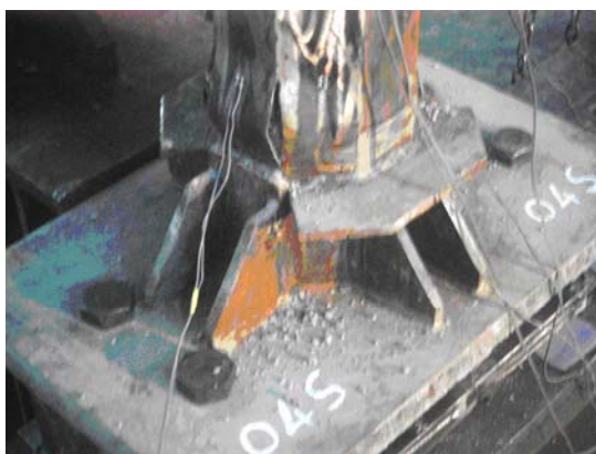
شکل ۳۱ شکست نمونه‌ی O4S در اثر کماتش موضعی جداره‌ی فولادی
