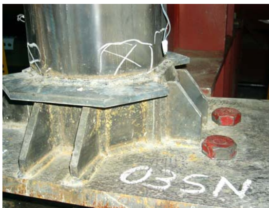
شکل ۳۵ شکست نمونه‌ی O3SN
