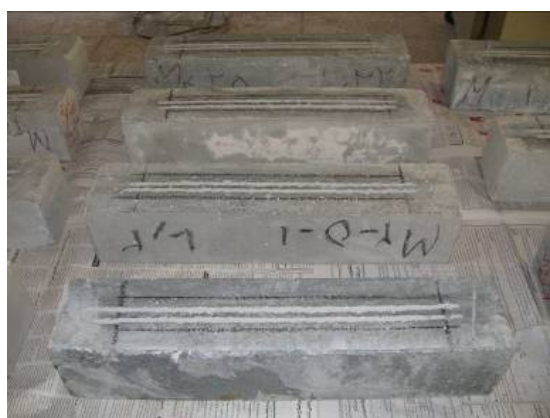
شکل ۲ مرحله‌های روش شیار زنی (ایجاد شیار- پر نمودن شیارها با اپوکسی مناسب)
