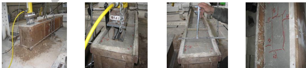
شکل ۱۰ مراحل بارگذاری تدریجی و شکست نهایی قالب کانالی B با ترک های شعاع
