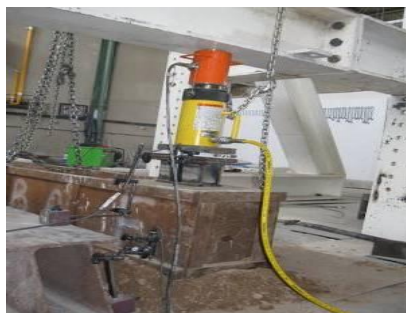
شکل ۷ نصب تغییر مکان سنج برای اندازه‌گیری تغییر مکان‌های قائم قالب‌ها
