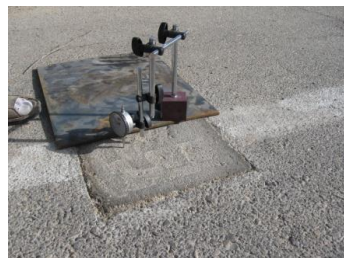
شکل ۱۳ ابزار و روش اندازه‌گیری نشست کانال‌های خیابانی پس از سه ماه
