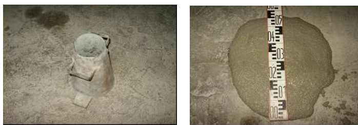
شکل ۱ آزمایش جریان اسلامپ و اندازه‌گیری میزان روانی مخلوط
