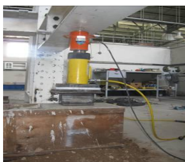
شکل ۶ نصب جک و بارسنج و ریختن خاک در زیر قالب
