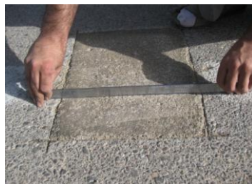
شکل ۱۳ ابزار و روش اندازه‌گیری نشست کانال‌های خیابانی پس از سه ماه
