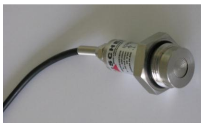
شکل ۵ فشارسنج برای اندازه‌گیری فشار جانبی خاک وارد بر دیوار
