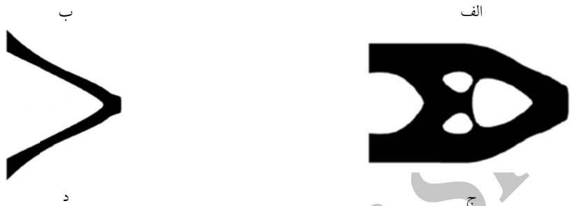
شکل ۱۸ برگرفته از [15] الف) تیر یک سر گیردار مستطیلی، ب) تغییرات تابع هدف و قید حجم، ج) تغییرات ساختاری در فضای فیزیکی و پارامتری مسئله، د) پروفیل بهینه
