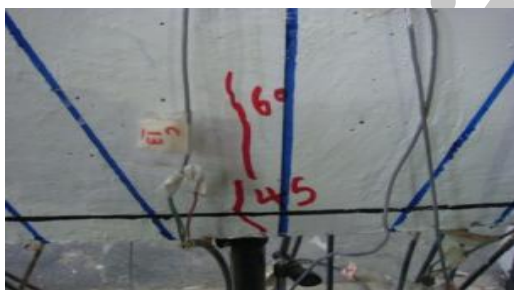
الف) اولین ترک در محل ممان حداکثر در نمونه‌ی (BFI)
