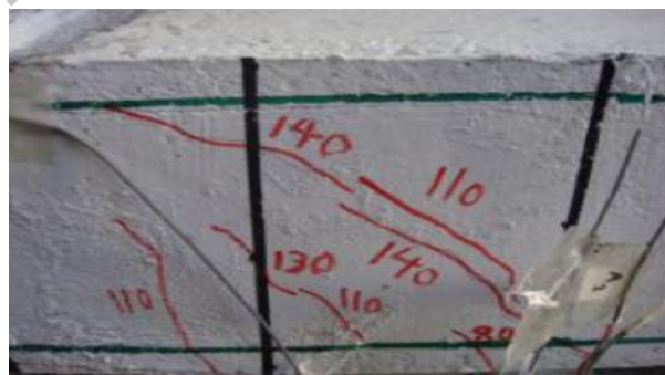
ب) اولین ترک برشی در بار 110\text{kN} در نمونه‌ی (BSV)
