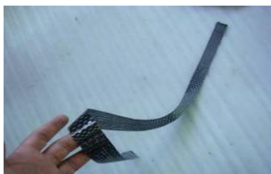
ب) الیاف FRP بریده شده برای خاموت تیرها
