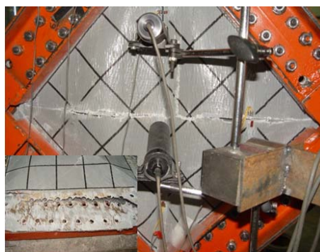
شکل ۱۶ گسیختگی اتصال ورق کامپوزیتی به اعضای مرزی و پارگی لایه‌ی پلیمری در امتداد قطری در نمونه‌ی CSPSP5
