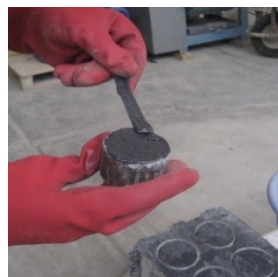
شکل ۵ اعمال چسب اپوکسی به استوانه‌ی فولادی
