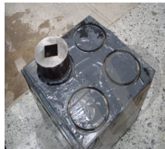
شکل ۶ چسباندن استوانه‌ی فولادی به سطح CFRP
