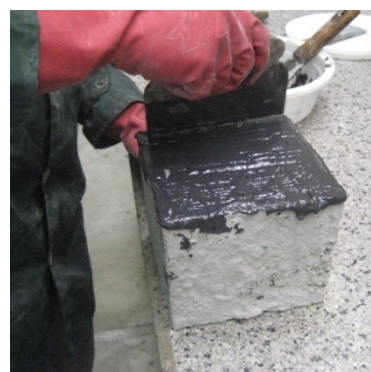
شکل ۲ اعمال چسب روی صفحه‌ی الیاف کربنی
