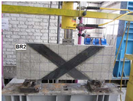
شکل ۴ آرایش CFRP در تیر BR2
