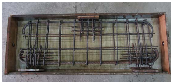
شکل ۱ جزئیات آرماتورگذاری و تقویت‌های صورت گرفته در محل اعمال بار و تکیه‌گاه‌ها برای جلوگیری از وقوع خرابی‌های لهیدگی تکیه‌گاهی
