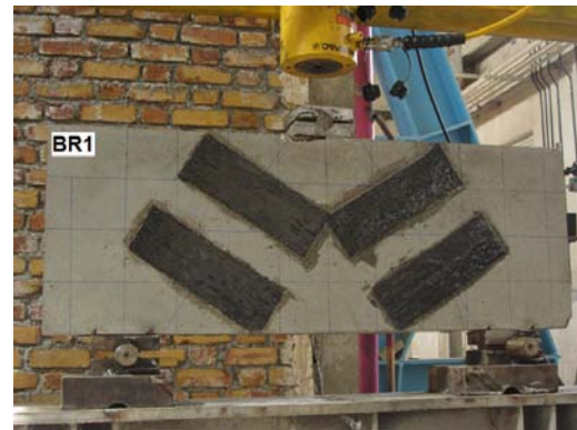
شکل ۳ آرایش CFRP در تیر BR1
