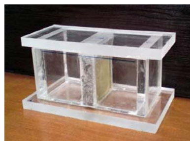
شکل ۲ شکل شماتیک مدل آزمایشگاهی برای سنگ مارن
