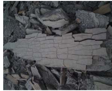
شکل ۱ هوازگی سنگ مارن دارای برونزد در منطقه
