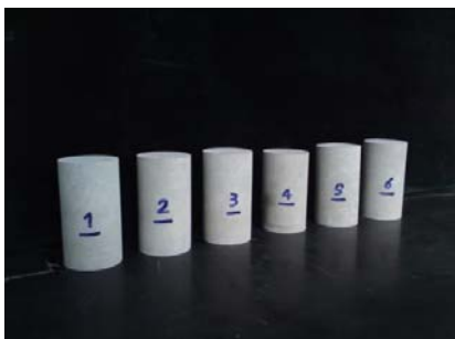
شکل ۴ نمونه‌های ماسه‌سنگ پس از مغزه‌گیری و برش
