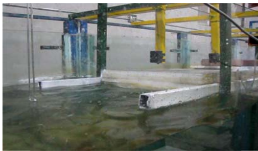
شکل ۹ سیستم مهاربندی قائم و افقی با هدف جلوگیری از حرکت افقی مدل در برابر امواج
