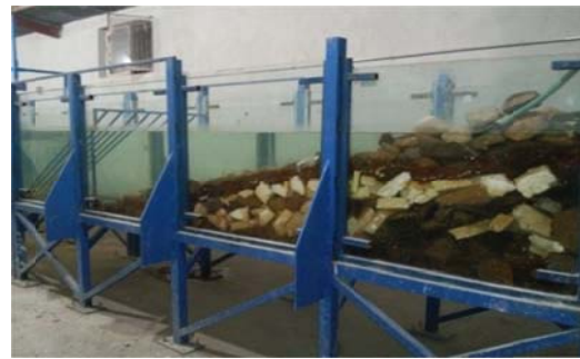
شکل ۷ ساحل انتهایی کانال آزمایشگاه هیدرولیک دانشگاه تحصیلات تکمیلی صنعتی و فناوری پیشرفته کرمان برای مستهلک کردن امواج در انتهایی کانال
