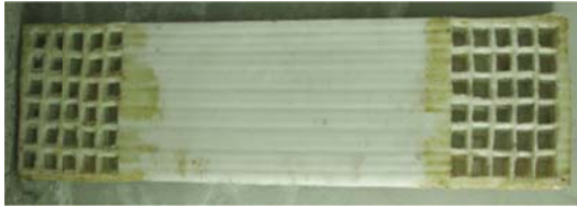
شکل ۴ تصویر بخش تحتانی مدل ساخته شده دارای سلول‌های گیل به عمق ۷/۵ سانتی‌متر و ابعاد ۶×۶ سانتی‌متر در دو سر مدل
