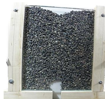
شکل ۸ نمونه‌ای از تصاویر قوس زدگی در مصالح
