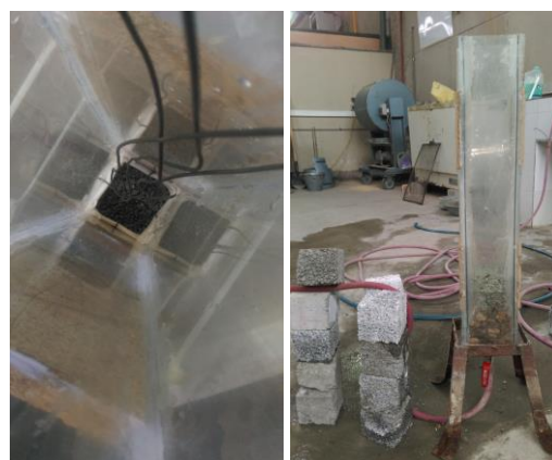
شکل ۴ دستگاه اندازه‌گیری ضریب نفوذپذیری و نمونه قرار داده شده در دستگاه
