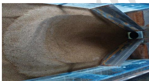
شکل ۱۵ هندسه چاله آبستنگی پایین دست کالورت دایره‌ای
