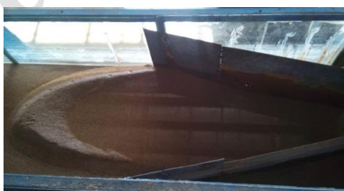
شکل ۱۶ هندسه چاله آبستنگی پایین دست کالورت مستطیلی
