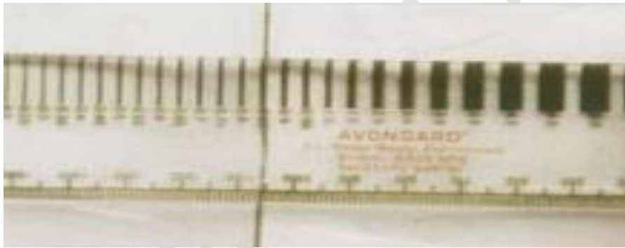
شکل ۴ خط‌کش مدرج اندازه‌گیری عرض ترک خوردگی
