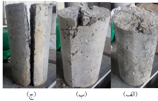
شکل ۲۳ گسیختگی کششی نمونه‌های استوانه‌ای تحت کشش غیرمستقیم
