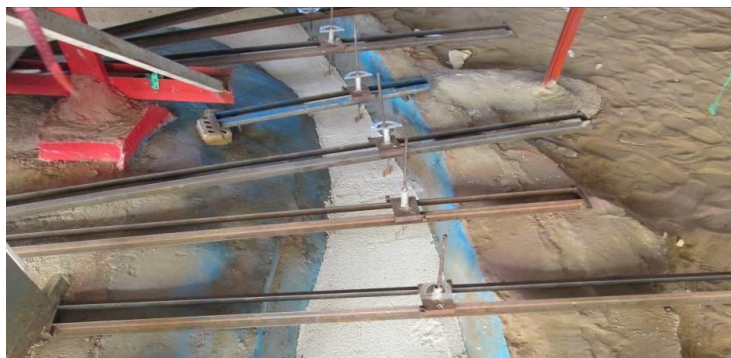
شکل ۴. نمایی از کارگذاری صفحات شناور در قوس قبل از انجام آزمایش
