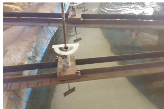
شکل ۵. نمایی نزدیک از نصب صفحات
