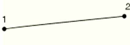
شکل ۵ المان خرابایی T3D2 [13]
