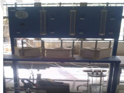
شکل ۶ دستگاه تست نفوذناپذیری آب طبق استاندارد EN 12390-8
