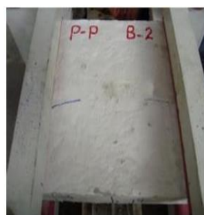
شکل ۶ وضعیت نمونه‌های پروپیلن پس از اعمال ضربات (ب) نمونه دوم PP-B2 پس از اعمال ۵۵ ضربه
