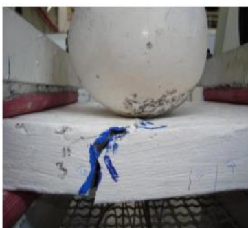
شکل ۷ وضعیت نمونه‌های PVA پس از اعمال ۱۰۰ و ۶۳ ضربه (ب) نمونه PVA-A2 پس از اعمال ۱۰۰ و ۶۳ ضربه
