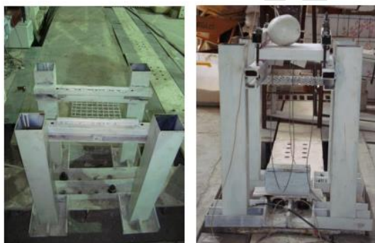
شکل ۳ جزئیات تکیه‌گاه آزمایش ضربه
