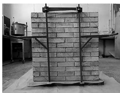
شکل ۵ سیستم حمل دیوار
