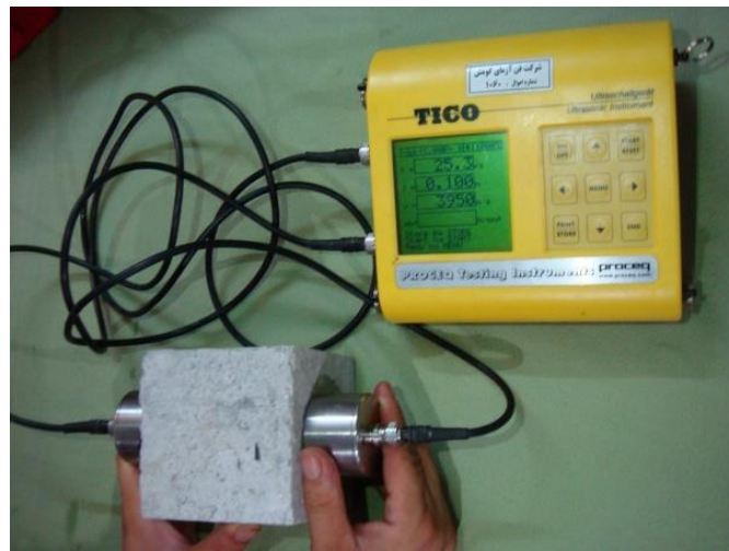
شکل ۹ انجام آزمایش اولتراسونیک (UPV)
