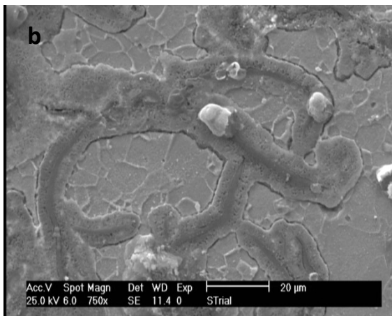
شکل ۱۲ مقایسه تصویر SME برای نمونه‌ها پس از ۴۱۲ سیکل شوک در بزرگنمایی ۷۵۰ از پشت شکاف نمونه، (a) نمونه کوئنچ شده در آب یخ، (b) نمونه کوئنچ شده در دوغاب ضد اکسیداسیون.
