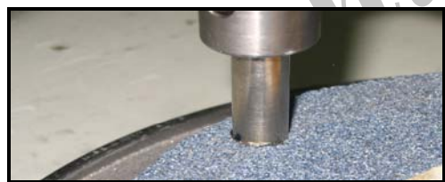
شکل ۱ تصاویری از دستگاه پین روی دیسک با استفاده از سنگ سایشی
