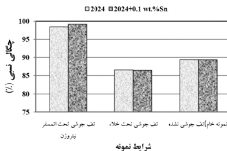
شکل ۶ نمودار تغییرات چگالی با تغییر محیط برای تف‌جوشی در دمای 610^{\circ}\text{C}
