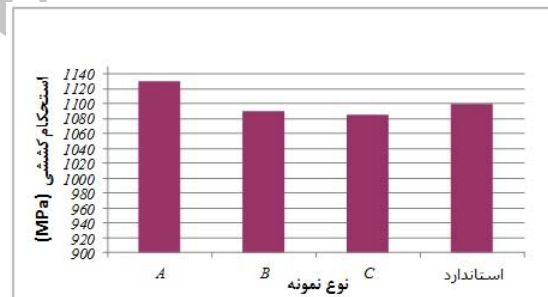
شکل ۷ استحکام کششی نمونه‌های آزمایش
