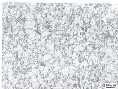
شکل ۱۰ اریز ساختار آلیاژ Al-17% Si ریخته شده در دمای ۶۲۰°C بر روی سطح شیب دار و اصلاح شده با ۱ درصد منیزیم (الف) و ۱ درصد منیزیم + ۰/۱ درصد استرانسیم (ب)
