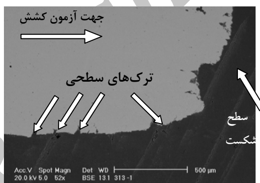
شکل ۶ تصویر میکروسکپ الکترونی روبشی از ترک‌های سطحی در مقطع طولی نمونه‌ی کشش مربوط به آلیاژ H
