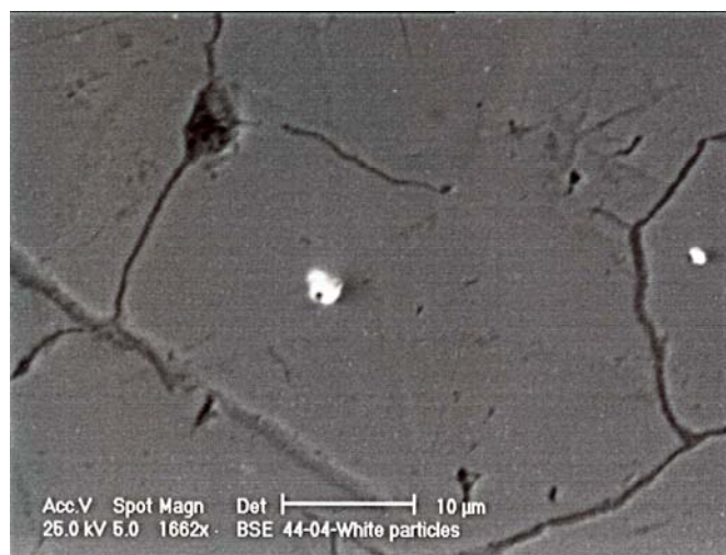
شکل ۸ تصویر SEM-BSE از یکی از آخال‌های روشن در ساختار اشیاء. این آخال‌ها فاز غنی از سرب هستند. بزرگ‌نمایی ۱۶۶۲ برابر.
