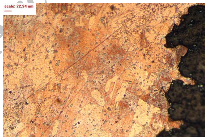
شکل ۱۰ ریزساختار نمونه‌ی HT.43 مشابه با نمونه‌ی HT.44 بوده و شامل دانه‌های تغییر شکل یافته و تبلور مجدد یافته‌ی محلول جامد آلفا است. نمونه در محلول آبی کلرید آهن III حکاکی شده است. بزرگ‌نمایی ۲۰۰ برابر
