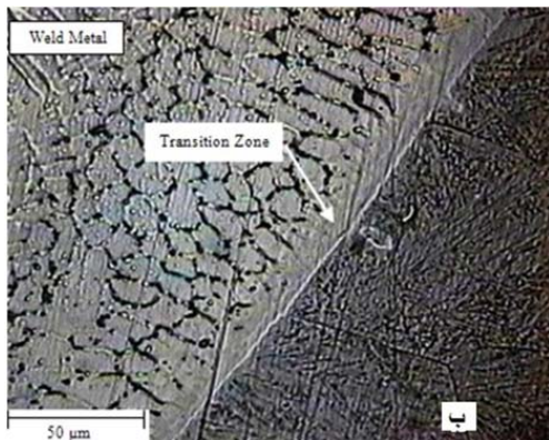
شکل ۷ منطقه‌ی انتقالی در نمونه‌ی جوشکاری شده با فلز پرکننده‌ی پایه نیکل؛ الف) توسط جریان ثابت و ب) توسط جریان پالسی
