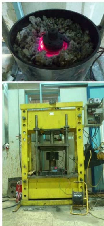
شکل ۳ دستگاه اکستروژن مورد استفاده در این تحقیق شامل کوره و پرس هیدرولیک ۶۰ تن
