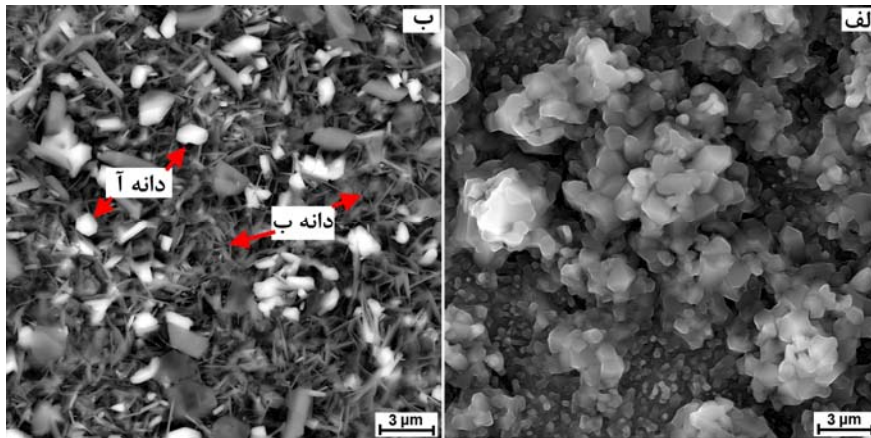
شکل ۱۰ تصویرهای میکروسکوپ الکترونی روبشی از سطوح ترکیبات Ti-48Al (الف) و Ti-48Al-5Mn (ب) اکسید شده به مدت ۸ ساعت در دمای ۹۰۰ °C
