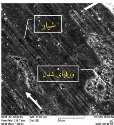
شکل ۱۷ تصویر میکروسکوپ الکترونی رویشی از سطح سایش نمونه‌ی کامپوزیتی AA8090/3%SiC تحت عملیات حرارتی رسوب‌سختی پس از کوئنچ جهت‌دار در بار اعمالی ۲۰ نیوتن
