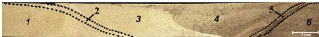
شکل ۴ تصویر با بزرگنمایی کم از مقطع عرضی نمونه جوشکاری شده
