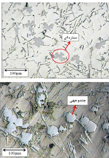
شکل ۶ اشکال مختلف ترکیبات بین فلزی ناشی از حضور آهن در نانو کامپوزیت تولید شده با ۰/۵٪ وزنی نانوسیلیس.
