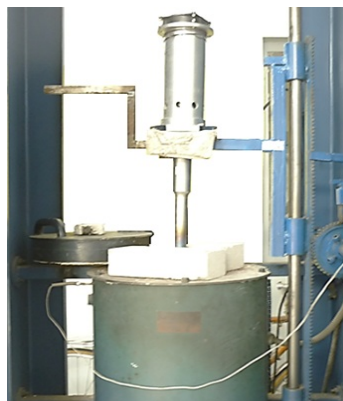
شکل ۲ دستگاه آلتراسونیک استفاده شده برای پخش نانو ذرات در مذاب.
