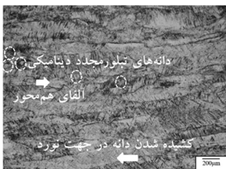
شکل ۴ ریزساختار حاصل از نورد گرم ثانویه در ناحیه دو فاز آلفا-بتا
