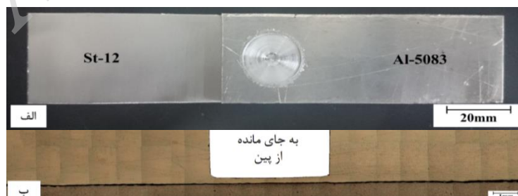
شکل ۱ الف) نمای کلی از جوش اصطکاکی تلاطمی نقطه‌ای و ب) نمای ماکروسکوپی از مقطع عرضی جوش پیش از آزمون کشش
