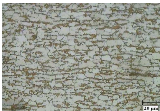
شکل ۹ تصویرهای میکروسکپ نوری از ریزساختار نمونه‌های فولادی ۷۰ درصد کار سرد شده برای مدت زمان ۵ دقیقه در دمای ۷۴۰ درجه سانتیگراد
