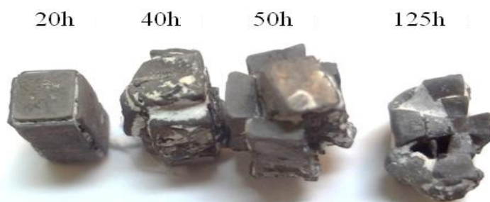
شکل ۲ نمونه های آلیاژ ریختگی بعد از آزمایش غوطه وری در دمای ۷۰۰ درجه سانتیگراد، به همراه محصولات سطحی حاصل بر روی وجوه آنها
