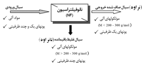
شکل ۱ شماتیک فرآیند نانوفیلتراسیون فاضلاب ستون رنگبری
