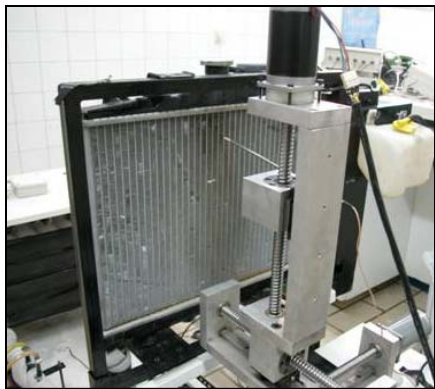
شکل ۶ مکانیزم انتقال دهنده و پراب سیم‌داغ در پشت رادیاتور
