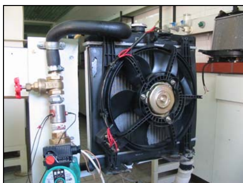
شکل ۵ بستر آزمون رادیاتور و فن
